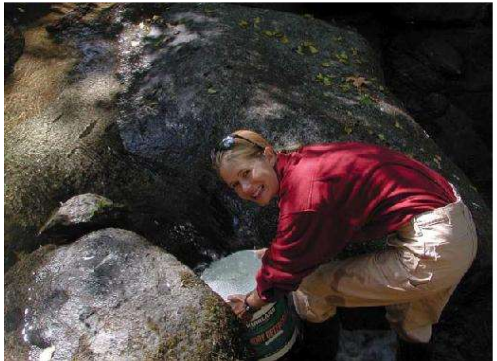
容量が決っている容器に実際水がどれだけの時間で満たされるかで流量を知る事が出来ます。
