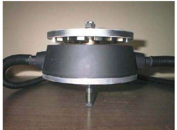
ES&D 社の発電機は写真上部に示されたように磁石を使用し、高効率を誇る小型タイプです。(磁石を見せる為に特別に上げた状態で、使用時には見えません)
