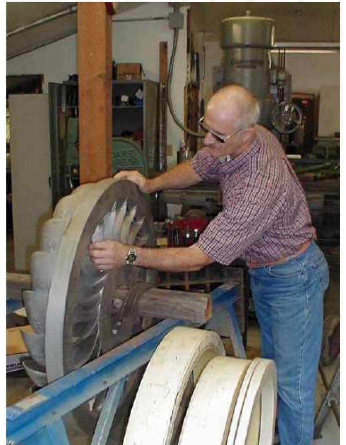
著者は重さ 450kg、ピッチ 22 インチ、ターボランナーを検査しています。このランナーは 880kW 発電用。
