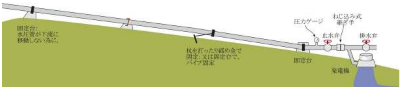
導水管の選定は予算、距離、高低差、流量で行います
