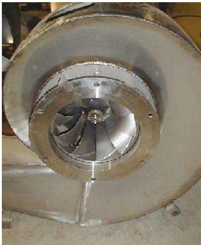
この写真はパワーパルの1.5メーターヘッド交流発電機で、フランシス応用です。下のランナーランナーハブが軸を経由して上側での発電機を回転させます。
