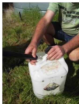
ニュージーランドの典型的な1月(真夏)の正午に測定:80秒で20リットル= $15\frac{L}{min}$ /分
