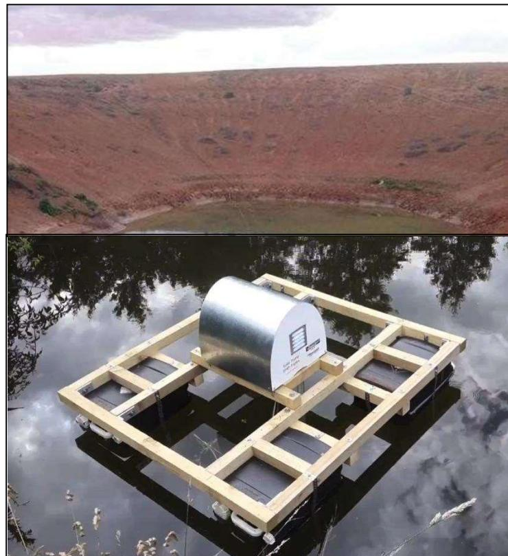
右上の写真は、オーストラリアの典型的なダムの中の、木材柵のあて木と 20リットルのUV耐性プラスチック容器 4個で作られた小さな浮舟上のPowerSpoutリアクトポンプです。黒の樹脂製貨物パレットも、リアクトポンプ用浮舟のベースとして最適で、これらの材料は一般的によく使われており、多くの場合無料です。
