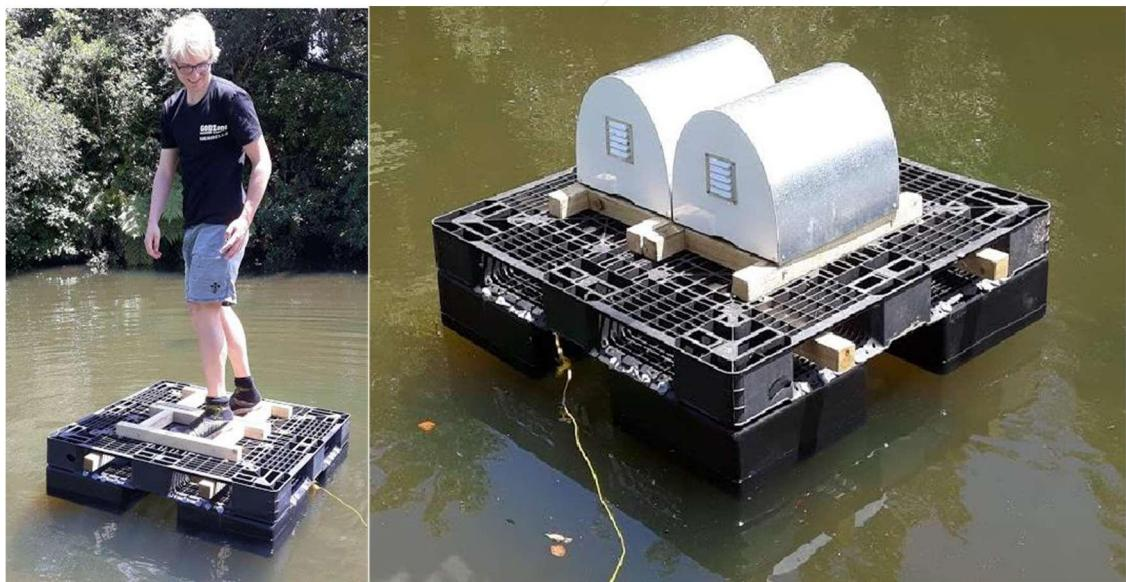
接続前の浮舟浮力の試験：吸入パイプ・フットバルブ・フィルター・電源配管・電源ケーブルは取り付けています
