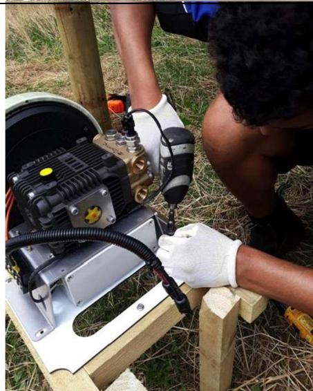
ポンプカバーが適合していることを確認します。これらのカバーは、生産モデルではステンレス鋼板製です。
