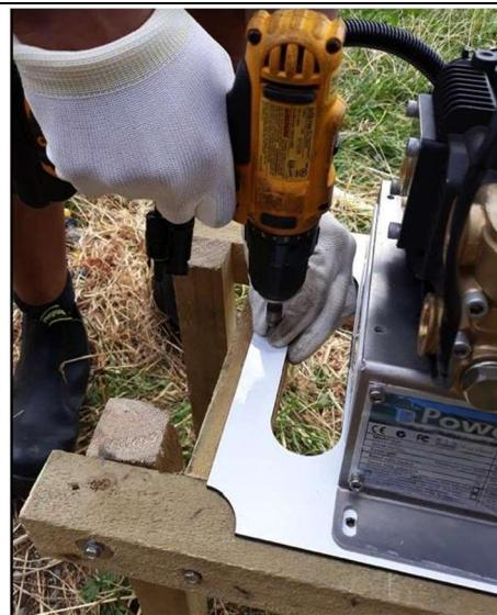
リアクトポンプアルミニウムベースを、50mmステンレステック4本で右写真のように取り付けます。
