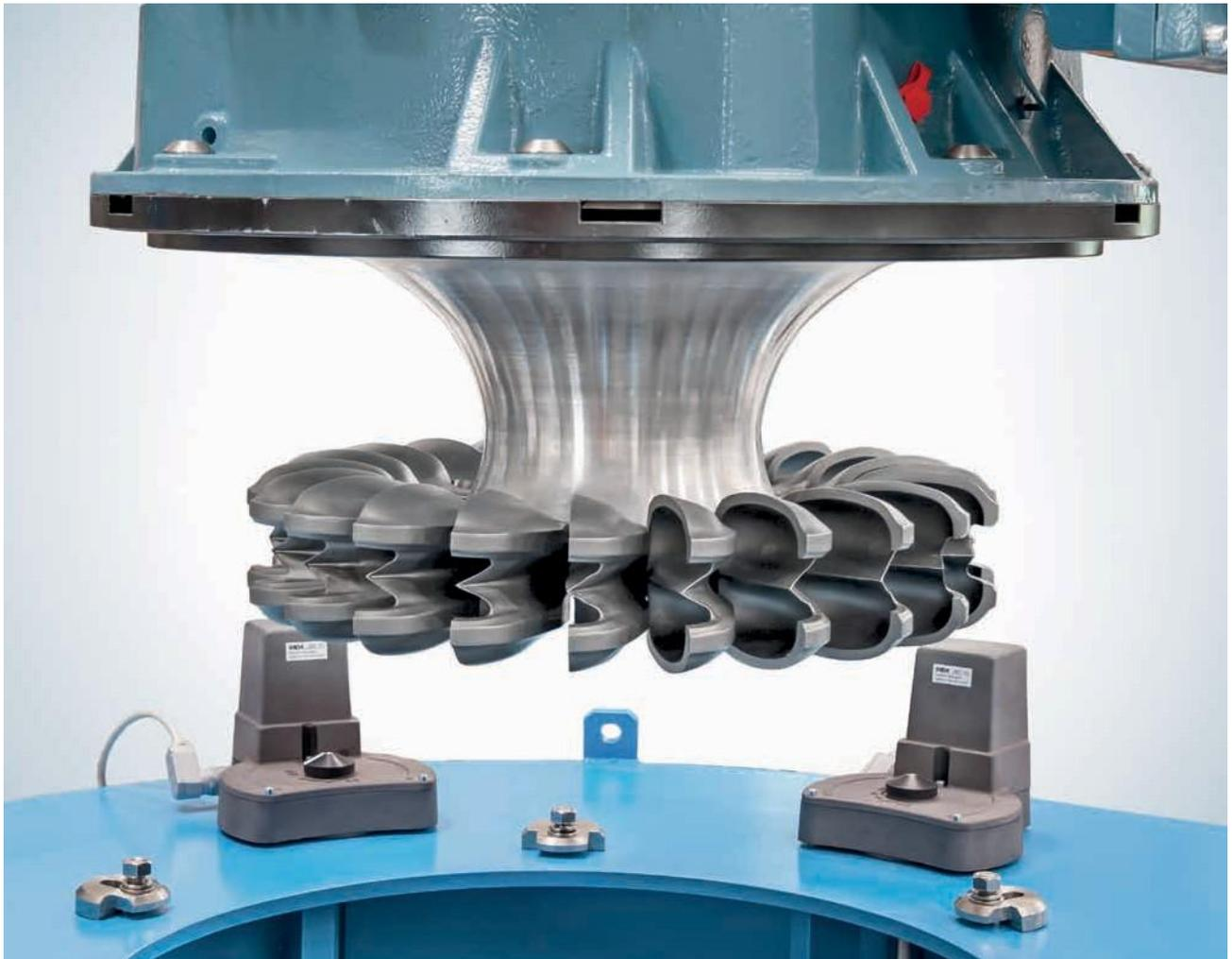
TPA - TPS は、耐久性と高品質を確保するために精密鑄造で作られたステンレス鋼のバケットで構成されたランナーを備えた垂直軸ペルトンタービンです。
