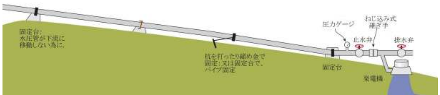
導水管の選定は予算、距離、高低差、流量で行います
