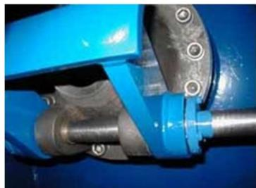
従来の横軸の場合、緊急水遮断板(ディフレクター)がジェットノズルから噴射している水をタービンに当たないメカニズムで、停電等送電ストップ時、水停止で発電を止めます。2ノズル機種が一般的であり、この止水方法は安価で確かに有効な方式です。(左写真)
