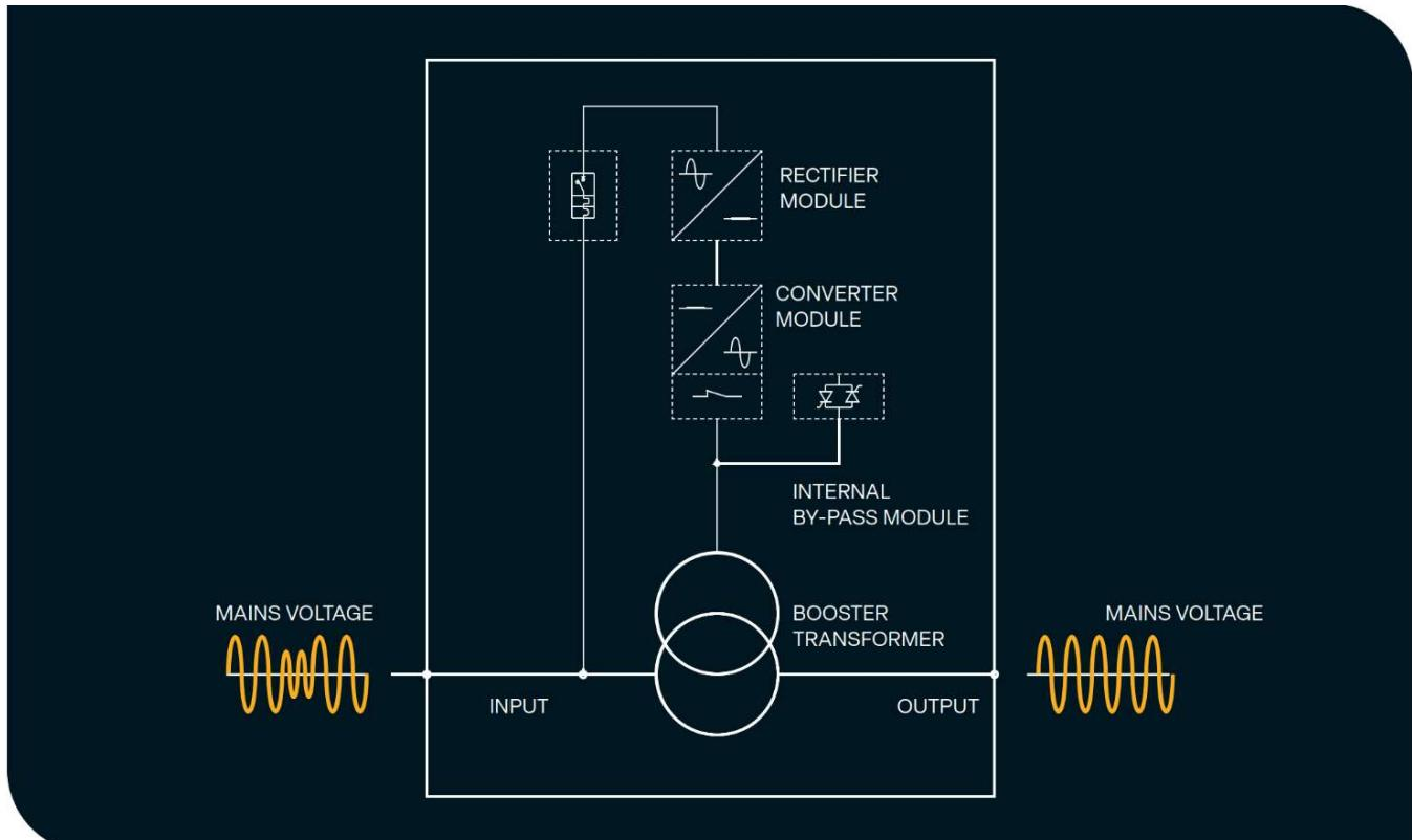
**電圧ディップ補償装置
